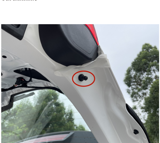
7. Снимите левую шаровую опору на багажнике
