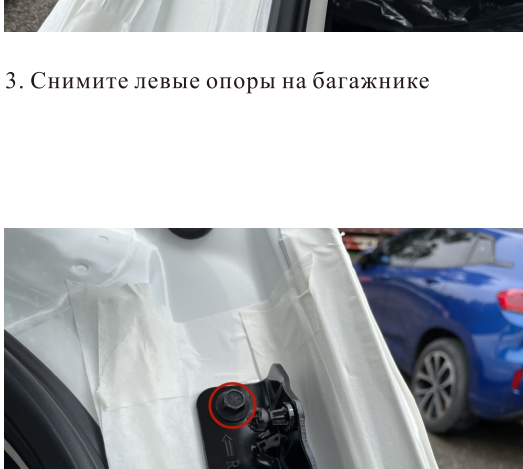
3. Снимите левые опоры на багажнике
