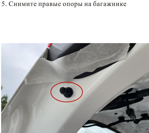
5. Снимите правые опоры на багажнике
