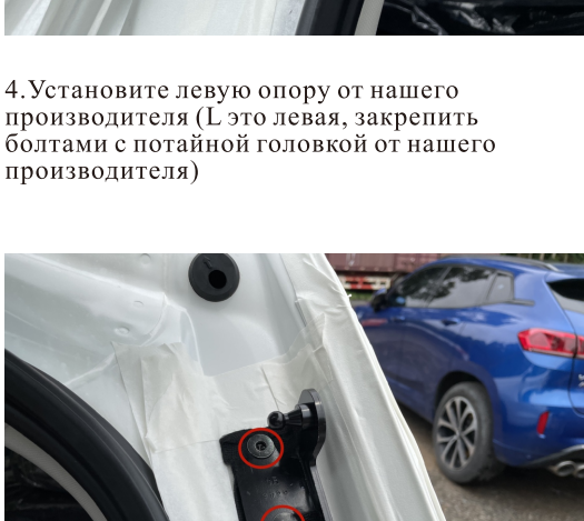
4. Установите левую опору от нашего производителя (L это левая, закрепить болтами с потайной головкой от нашего производителя)
