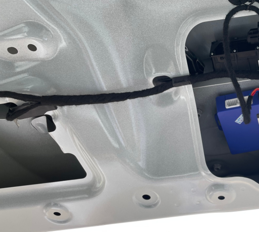
7. Как на фото, CAN-H провод подсоединяется с коричневым проводом, CAN-L с синим и чёрным проводом
