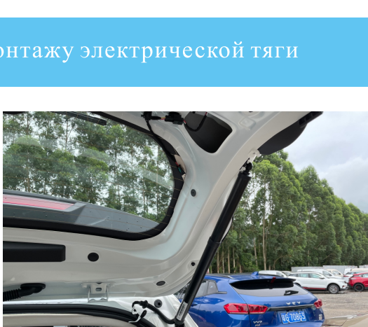
10. Поставьте большую прокладку от нашего производителя и установите шаровую опору обратно
