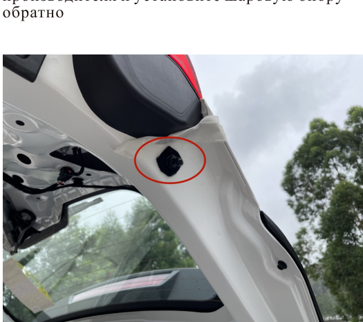
8. Поставьте большую шайбу от нашего производителя и установите шаровую опору обратно
