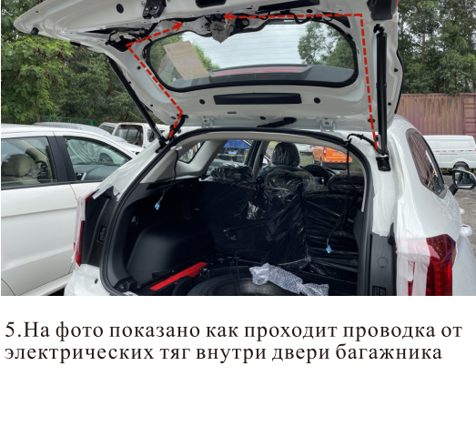
3. Как показано на фото, провода от тяги проходят через специально оставленное для них отверстие
