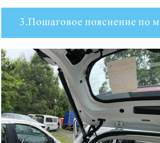
9. Снимите правую шаровую опору на багажнике
